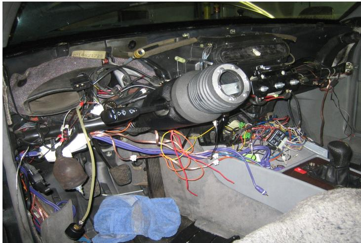
Nicht erschrecken, hier ist noch ein HiFi-Umbau drin und das links ist eine Soganzeige für den Pöl-Umbau. Das Handtuch dient zum Auffangen eventueller Kühlmittelreste.
